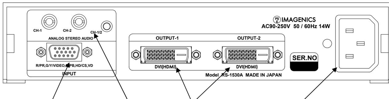
アナログ映像入力 ( INPUT R/PR G/Y/VIDEO B/PB 各 75 HD/CS VD 各 2.2k ミニ D-SUB15 )
