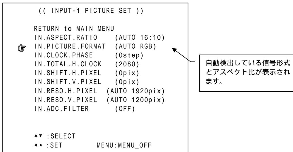
工場出荷設定時は共にAUTOです。入力信号を映像表示している状態で、必要に応じて切替えます。通常は共に AUTO 設定のままご使用ください。このとき、PC 映像とハイビジョン、NTSC/PAL ビデオなどのテレビ系映像とアスペクト比を全自動判別して動作します。自動対応可能なテレビ信号については、次の表を参照ください。また PC 映像の場合、VESA 規格に準拠している映像のみ自動でワイド表示となります。
