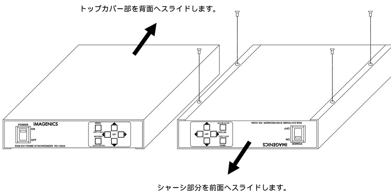
トップカバーとシャーシを分離するには、まず、トップカバーの下部合計 4 本の M3-サラネジを取り外し、左図のようにシャーシ部を手前へ、トップカバーを背面側にスライドさせて分離します。
