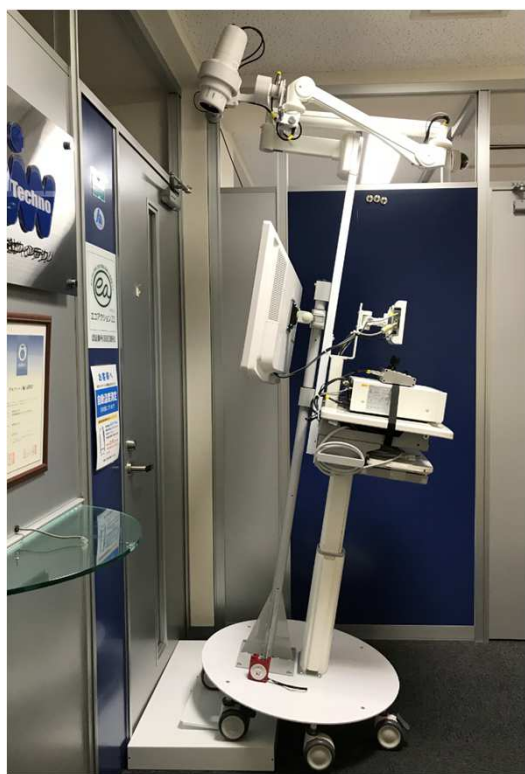
操作者側傾斜アームおりたたみ、 カート最長の状態TEST
